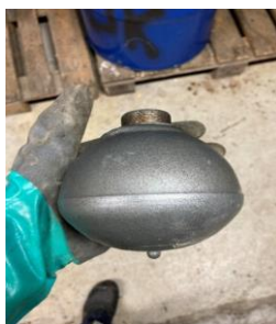
Eks. på fremmedlegemer som kan føre til havari på kverner
