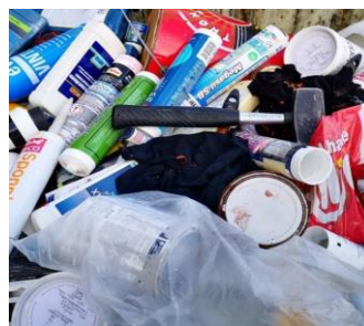
Innblandet «søppel» som filler og hammer kan føre til driftsstans
